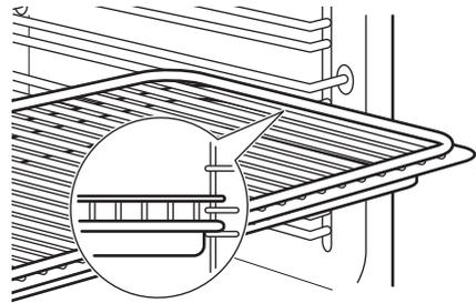
**i** Die kleine Einkerbung auf der Oberseite erhöht die Sicherheit. Diese Einkerbungen dienen auch als Kippsicherung. Durch den umlaufend erhöhten Rand des Rosts ist das Kochgeschirr gegen Abrutschen vom Rost gesichert.
